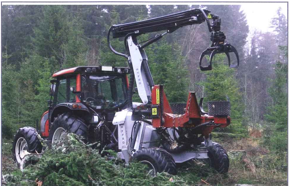
Le modèle Hypro 755 HB est équipé en standard de béquilles hydrauliques.
